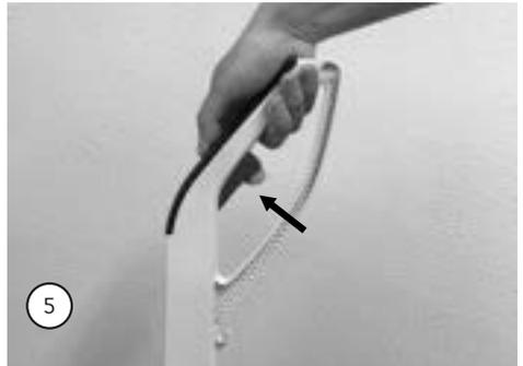
5. Deslize o dispositivo para frente ao longo da borda do tapete e mantenha pressionado o botão de pulverização (9) a fim de pulverizar a solução de limpeza na superfície.
