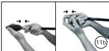
11b. Após encaixar o bico empurre a ponta da lança, até voltar a posição inicial, e certifique-se de que está travado.
