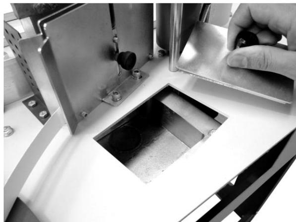
Se necessário insira cola adequada com a cor da madeira e fita de borda que você está usando. Não coloque quantidade demasiada de cola, pois a mesma ao derreter e durante o funcionamento da máquina pode transbordar e causar vazamentos. Também não deixe faltar cola no coleiro, pois isso pode causar falhas na colagem.
