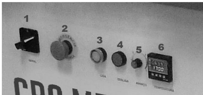
1. Ligue a chave seccionadora (1). Essa chave energiza o painel da máquina, porém sem ligá-la.
