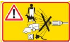
**ATENÇÃO:** Jatos de alta pressão podem ser perigosos se utilizados incorretamente. O jato nunca deve ser direcionado a pessoas, equipamentos elétricos ou a própria máquina de pressão.
