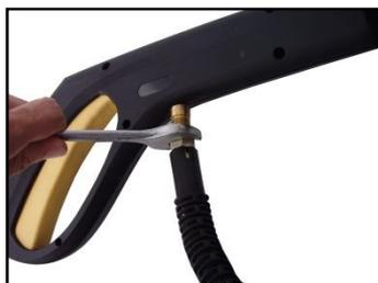
Garantir que a mangueira de entrada tenha um orifício com pelo menos 13 (treze) mm de diâmetro e que seja reforçado. A torneira de abastecimento de água deve garantir minimamente uma vazão de 10 (dez) l/min. **A temperatura da água que entra NÃO deve ser superior a 50°C. A pressão de alimentação de água NÃO deve ser superior a 10 (dez) bar.**
