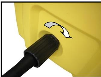
5. Conectar a pistola com a mangueira de alta pressão: rosqueando com as mãos e após apertando 1/8 de volta a conexão com uma chave de boca (nº 17).
