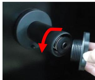
Encaixe o rolo de arame sobre o suporte e reponha o apoio livre e a porca apertando-a. Observe que o rolo deve estar devidamente encaixado;
