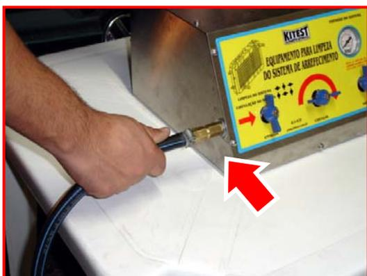
Encaixe a mangueira de água na conexão adaptadora e use uma abraçadeira para prende-la
