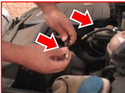
Encaixe o engate rápido referente ao sistema na mangueira de retorno do radiador e a mangueira adaptadora no reservatório utilize a abraçadeira
