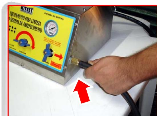
**E encaixe a encaixe no bocal de descarte de líquido usado**
