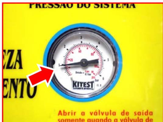
Abra o registro de fornecimento de água mantendo a pressão do sistema em 1 bar
