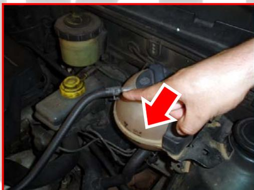
Retire a mangueira de retorno do reservatório de expansão
