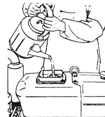
Fig. 6 Colocar água limpa no radiador
