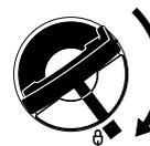
Posicionar a tampa do tanque com aba de fechamento (tampa do tanque baioneta) corretamente, girá-la até o encosto e então baixar a aba.
