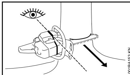
Esta motosserra está equipada com uma linha de orientação que está na cobertura e na carcaça do ventilador. Utilizar esta linha de orientação.
