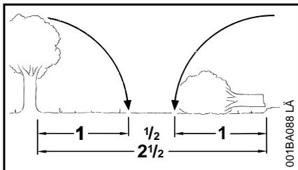
A distância entre os pontos de corte deve ser de no mínimo 2 1/2 vezes o comprimento da árvore.
