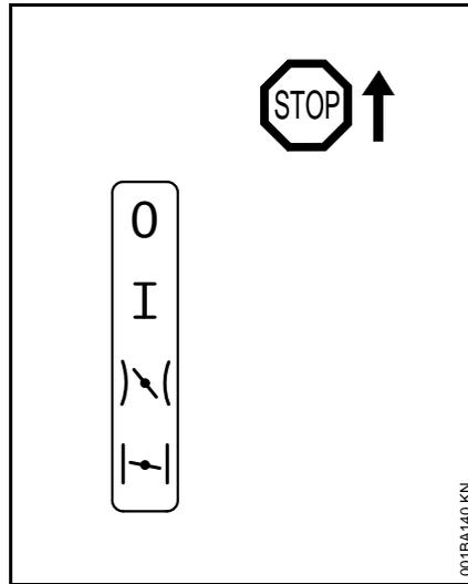
**Stop 0** – motor desligado – ignição está desligada
