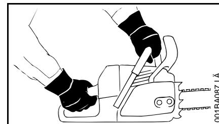
Sempre segurar a máquina **com as duas mãos**: mão direita no cabo traseiro, mesmo para canhotos. Para um manuseio seguro, envolver o cabo do punho e o cabo da mão firmemente com os polegares.
