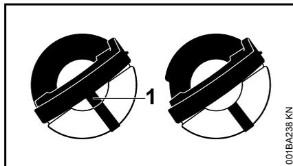
esquerda: parte inferior da tampa do tanque está virada – marcação interna (1) está alinhada com a marcação externa
