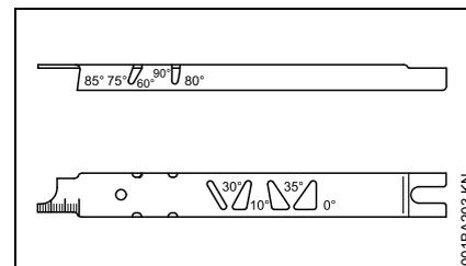
O calibre de correntes STIHL (acessório especial, veja tabela "Ferramentas para afiação") é uma ferramenta universal para controlar o ângulo de afiação e frontal, a altura do limitador de profundidade, o
