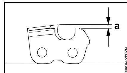
O limitador de profundidade determina a profundidade de penetração na madeira e, por consequência, a espessura das aparas.
