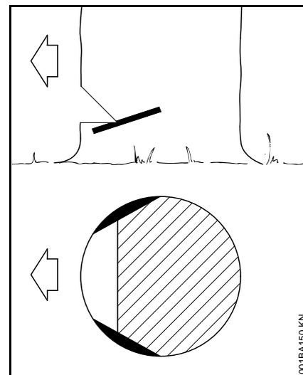
No corte de árvores com fibras longas, os cortes de alburno evitam possíveis rachaduras ocasionadas pela queda. Os cortes de alburno devem ser feitos
