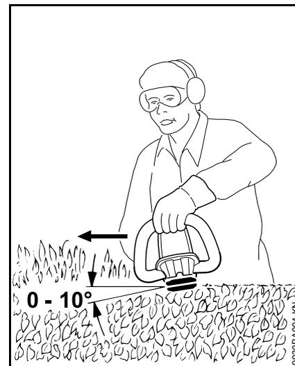
Posicionar a lâmina de corte num ângulo de  $0^\circ$  até  $10^\circ$ , mas conduzir a máquina na horizontal.
