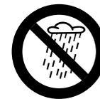
Não trabalhar com a máquina na chuva ou em locais muito úmidos, pois o motor não tem proteção contra água. **Perigo de choque elétrico e curto circuito!**
