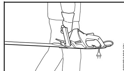
Transportar a máquina segurando no punho e com a lâmina apontando para trás.
