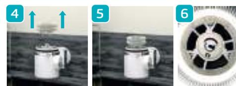
Segure a resistência e puxe-a para cima a fim de remove-la. Para colocação da nova resistência, observe a posição correta de encaixe, conforme ilustração (6). Encaixe e force até fixar bem nos pinos de contato.
