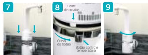
Verifique se a chave seletora está no final do curso a direita. A tampa superior possui um dente que deverá encaixar no corpo antes da chave seletora de temperatura. Encaixe e gire no sentido horário para junção da tampa superior e o corpo. Ligar o disjuntor e verifique o funcionamento.
