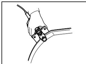
Recortes, cortes curvos em folheado de móveis e cortes semelhantes podem ser feitos facilmente com a guia de recorte. O rolete da guia desloca-se seguindo a curva e assegura um corte de precisão.
