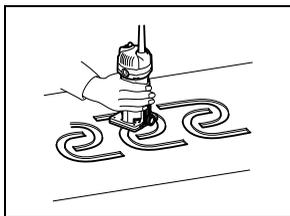
O modelo guia proporciona uma manga através da qual a broca passa, permitindo o uso da recortadora com padrões do modelo.
